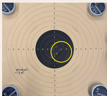
Elektrochemisch gezogener Lauf Streukreis 25 Meter = 15 cm
