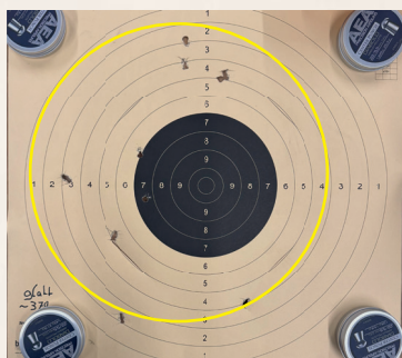
Glattes Rohr Streukreis 25 Meter = 40cm
