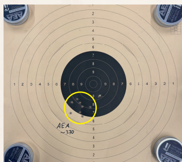
Frei verkäuflicher Luftgewehrlauf Streukreis 25 Meter = 12 cm
